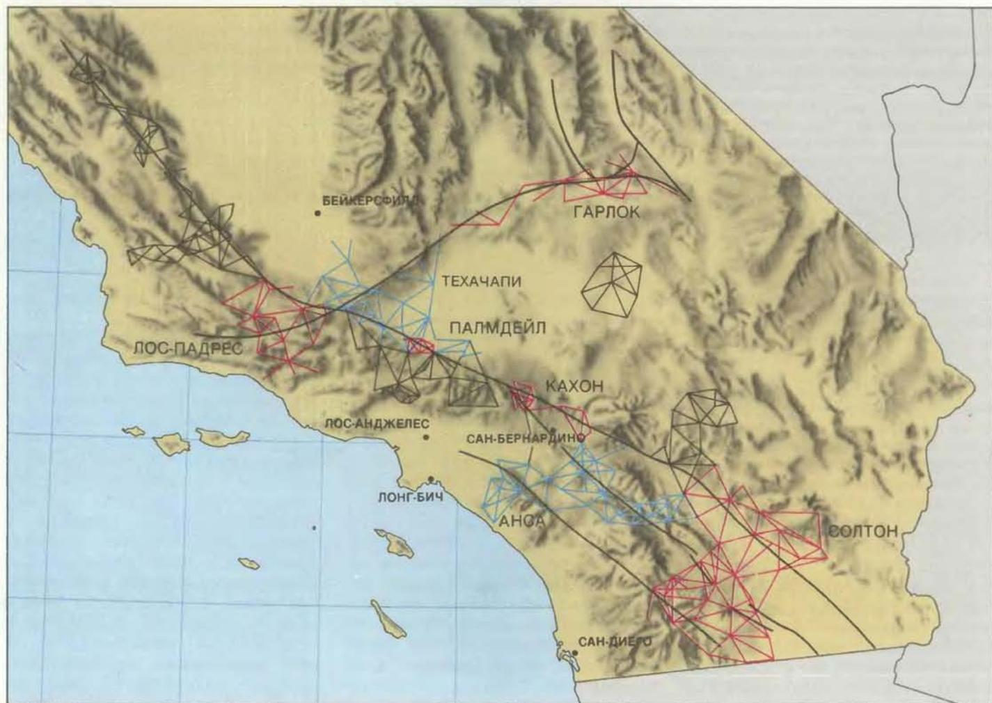
**СЕТЬ ЛАЗЕРНЫХ ДАЛЬНОМЕРОВ** образует систему треугольников, стороны которых пересекают в разных направлениях разлом Сан-Андреас в южной Калифорнии. Для каждого звена этой сети регулярно измеряется время распространения по нему лазерного луча и затем определяются длины базовых линий, имеющих среднюю протяженность до 30 км. Наблюдаемые изменения длин этих линий
