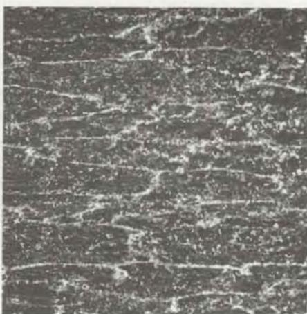
**ВЛИЯНИЕ КОВКИ** на дамасскую сталь было имитировано прокаткой образцов современной сверхвысокоуглеродистой стали. Структура стали показана с увеличением  $\times 130$  (вверху) и  $\times 6,5$  (внизу). До прокатки (слева) светлая цементитная сетка была непрерывной, с примерно одинаковым размером ячеек во всех направлениях. После прокатки (справа) сетка удлинилась в направлении прокатки и раздробилась на отдельные сферические частицы. В результате металл стал более вязким (менее хрупким).
