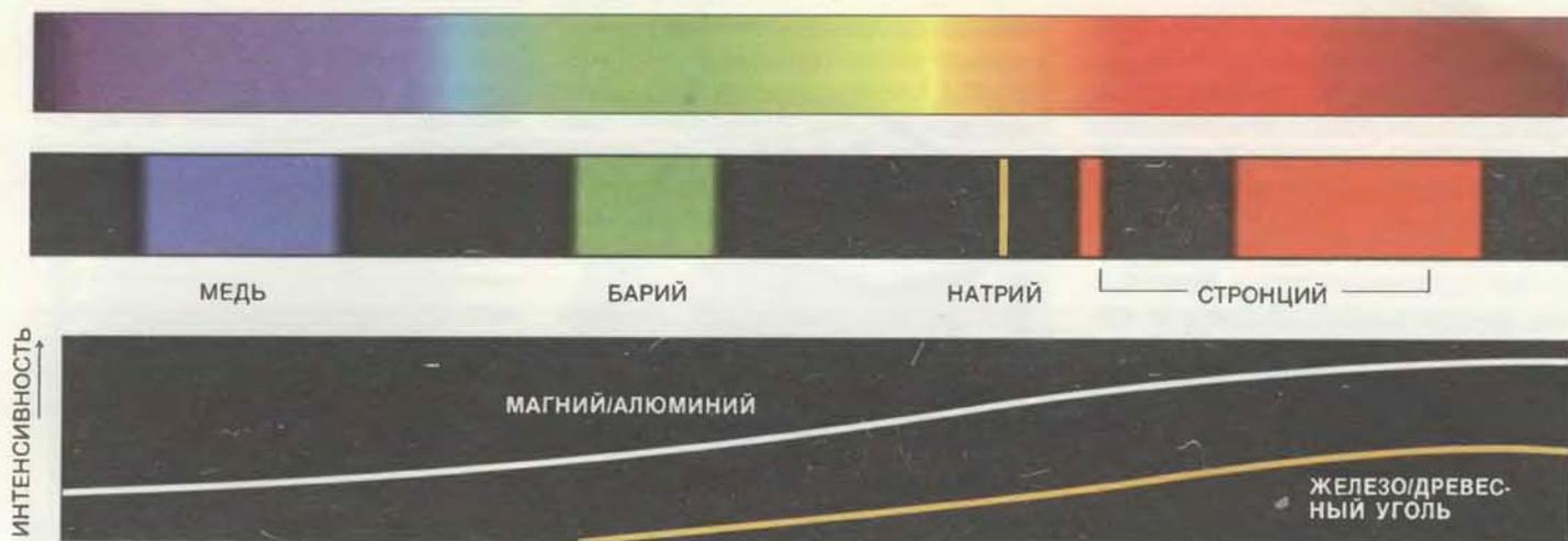
СВЕЧЕНИЕ обусловлено температурным нагревом, атомарным и молекулярным излучением. Его цвет зависит от того, в какой области видимого спектра излучается основная часть энергии (вверху). Атомы и молекулы возбуждаются при нагревании в пиротехническом пламени до высоких температур и выделяют избыточную энергию в виде света. Атомарный натрий является интенсивным источником желто-оранжевого излучения. Непрочные соедине-
