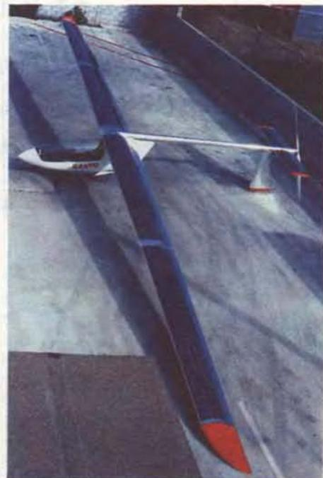
САМОЛЕТ компании Sanyo, приводимый в движение легкими гибкими солнечными батареями.
