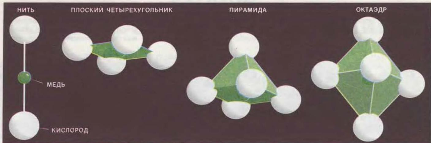
ЭЛЕКТРОННЫМ «СЕРДЦЕМ» почти всех высокотемпературных сверхпроводников является химическая связь между атомами меди и кислорода. Атом меди может соединяться с атомами кислорода четырьмя способами, кото-
