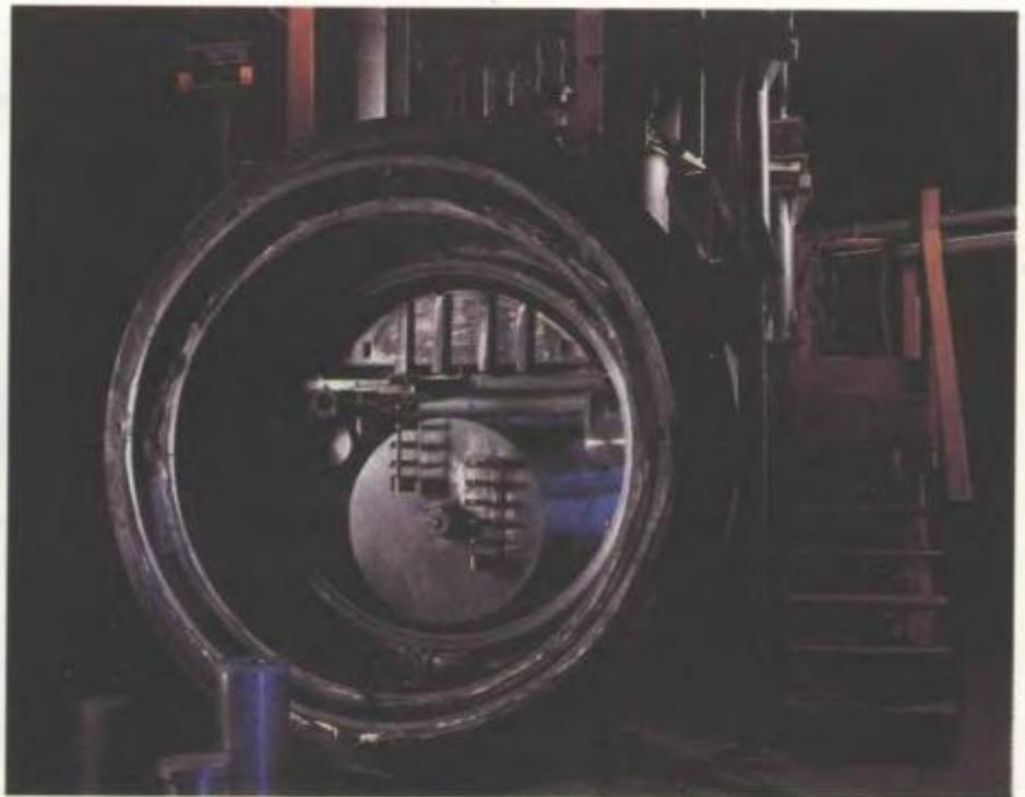
ЦИЛИНДРИЧЕСКИЙ ДЕТЕКТОР был построен специально для регистрации гравитационных волн. Гравитационная волна, проходящая через детектор, должна создавать деформации алюминиевого цилиндра, подвешенного в вакуумной камере. Деформации и вибрации можно зарегистрировать. Специальное оборудование в лаборатории Станфордского университета охлаждает цилиндр до температуры 4К, позволяя свести к минимуму вредные вибрации, вызываемые теплом.
