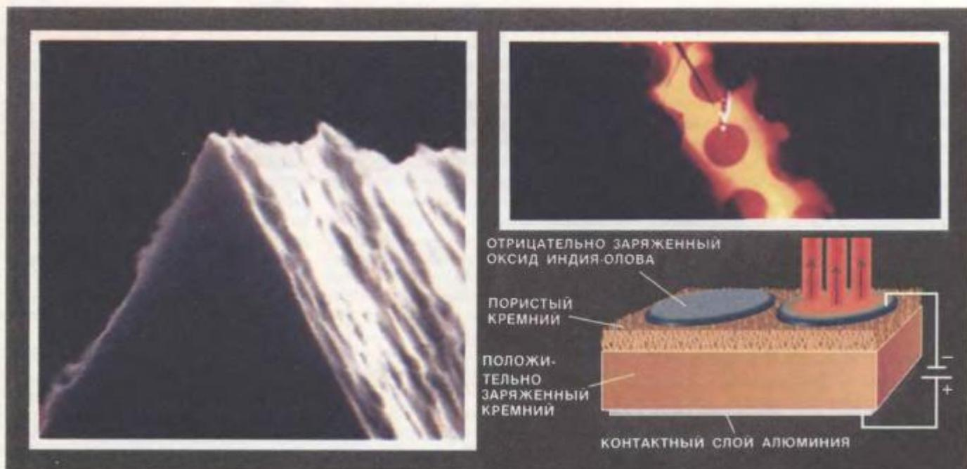
НЕОБЫЧНЫЕ светоизлучающие полупроводниковые приборы получены учеными из Исследовательского института Триэнгл, которые вытравили «квантовые проволоочки» на кристалле германия (слева). Пористый кремний, полученный учеными корпорации Spire, также светится при
