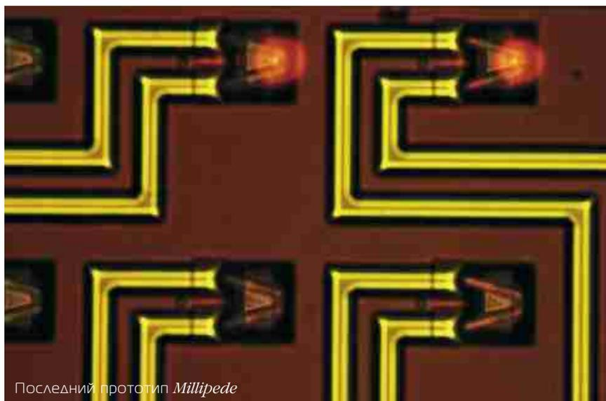
деялись получить поддержку после демонстрации работающего прототипа на Международном симпозиуме разработчиков микроэлектромеханических систем, проходившем в январе 1998 г. в Институте инженеров-электротехников и электронщиков (*IEEE*) в Гейдельберге, Германия. Нами была представлена матрица 5 на 5 щупов со встроенными пьезоэлектрическими преобразователями для регистрации отклонений. Площадь устройства составила 25 мм<sup>2</sup>.
