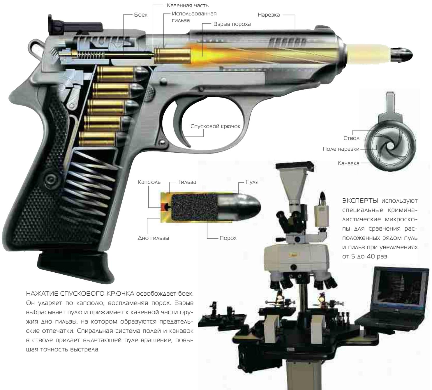
ЭКСПЕРТЫ используют специальные криминалистические микроскопы для сравнения расположенных рядом пуль и гильз при увеличениях от 5 до 40 раз.
