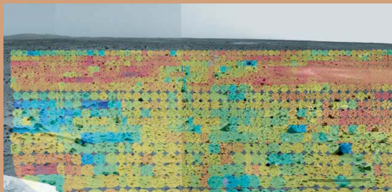
РЕЗУЛЬТАТ ТЕПЛОВОГО СКАНИРОВАНИЯ области от группы Восточных холмов до Сонной ложины. Пыль, тепловая инертность которой мала, теплее (красный цвет): она быстро нагревается солнцем. Камни обладают большей тепловой инерцией и дольше остаются холодными (синий цвет). Другие данные, полученные от инфракрасного спектрометра, свидетельствуют о присутствии карбоната магния и гидратированных минералов. Пока не ясно, как это связано с водяным прошлым кратера Гусева.
