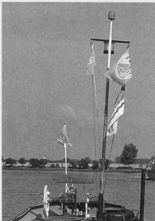
Клотик (от нидерл. kloot — шар, набалдашник) — на- вершие закругленной формы с выступающими краями на верхнем конце мачты или флагштока для подъема фонаря или флага.
