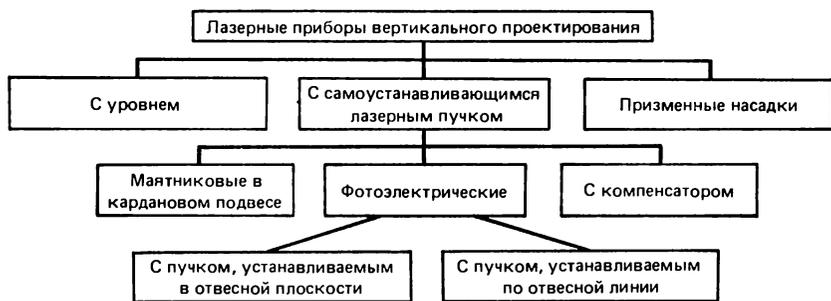
Рис. 59. Классификация лазерных приборов вертикального проектирования
