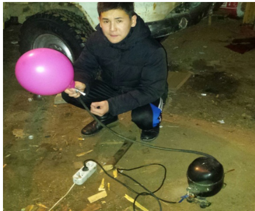
Рис. 4. Первый эксперимент: с помощью самодельного насоса накачали воздушный шар
