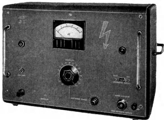
Стабилизированный выпрямитель типа ВС-16 представляет собой прибор, предназначенный для питания стабилизированным напряжением фотоэлектронных умножителей и других радиофизических устройств в лабораторных условиях.
