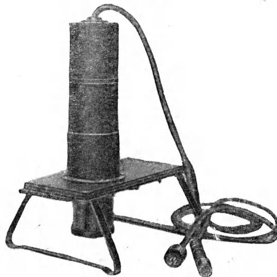
Сцинтилляционная приставка к установке Б-2 представляет собой стационарный лабораторный прибор, предназначенный для измерения активности альфа-препараторов и измерения альфа-загрязненности поверхностей при совместной работе с установкой типа Б-2.
