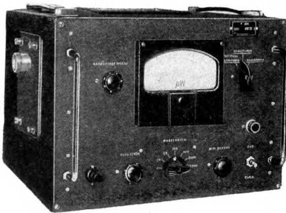
Измеритель малых мощностей типа ВИМ-1 является лабораторным прибором, предназначенный для измерения мощностей непрерывных и импульсно-модулированных колебаний с помощью сменных термисторных головок.
