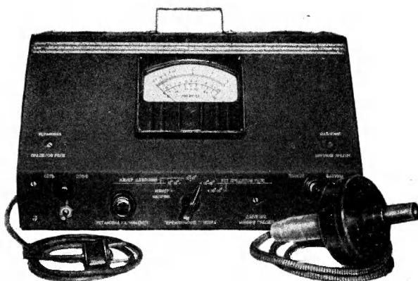
Магнитный блокировочный вакуумметр типа ВМБ-1 — лабораторный измерительный прибор, предназначенный для измерения низких давлений в замкнутом объеме и автоматического выключения электрических цепей других приборов при увеличении давления в вакуумной системе.
