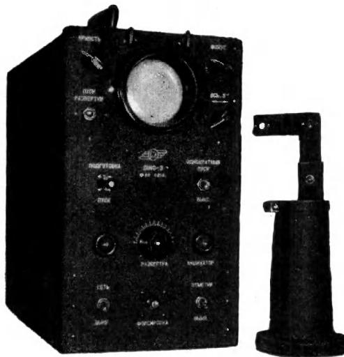
Осциллограф однократного действия типа ОЖО-3 предназначен для определения расстояния до места заплывающего пробоя в кабельных линиях высокого напряжения. Расстояние определяется путем измерения по осциллограмме длительности периода собственных затухающих колебаний в кабеле, вызванных пробоем в месте повреждения, при приложении к кабелю испытательного напряжения от кенотронной установки.
