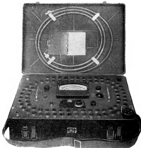
Сpirальная измерительная линия типа ИСЛ-1 предназначена для проверки УКВ антенн и фидеров в диапазоне частот 100—150  $M\text{гц}$ .
