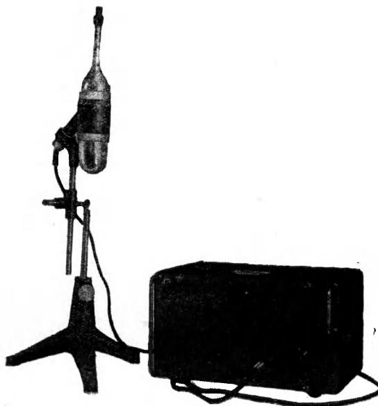
Измерительный конденсаторный микрофон типа МИК-5 предназначен для измерения звуковых давлений.
