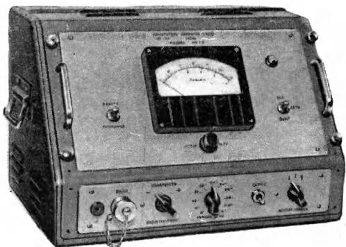
Измеритель скорости счета представляет собой лабораторный переносный прибор, предназначенный для определения средней скорости поступления импульсов, статистически распределенных во времени, и может быть использован для определения частоты периодических импульсов.
