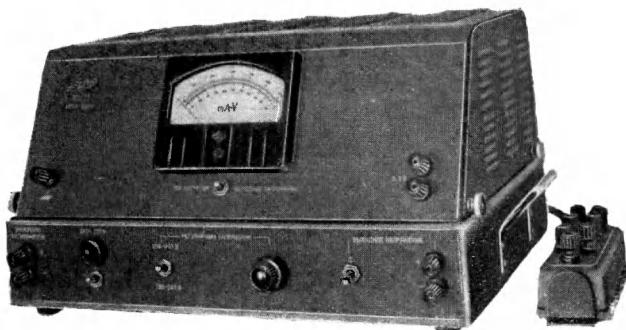
Стабилизированный выпрямитель типа ВС-11 представляет собой прибор, предназначенный для питания стабилизированным напряжением различных радиотехнических устройств в лабораторных условиях.
