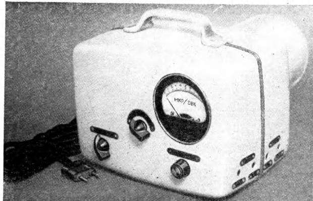
Микрорентгенметр типа МР-1 предназначен для измерения малых мощностей доз рентгеновского и гамма-излучения с энергией излучения от 50 кэв до 2 мэв.
