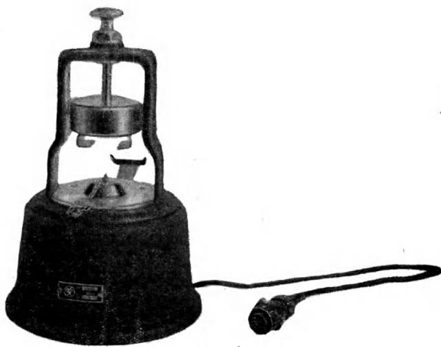
Прибор «искусственное ухо» типа ИУ-11 представляет собой измерительный микрофон, снабженный замкнутой камерой. Прибор предназначен для измерения звукового давления, развиваемого телефоном при акустической
