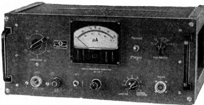
Сверхширокополосный усилитель типа УСШ-2 предназначен для усиления импульсных сигналов малой длительности и синусоидальных сигналов высокой частоты в лабораторных и заводских условиях.
