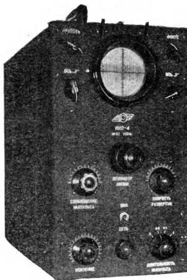
Измеритель кабельных линий типа ИКЛ-4 представляет собой переносный прибор, предназначенный для измерения расстояния до места повреждения в кабельных линиях в случае короткого замыкания одной или нескольких фаз кабеля при величине переходного сопротивления в месте повреждения до 200 ом, а также обрыва одной или всех фаз с величиною сопротивления утечки, значительно превышающей волновое сопротивление кабеля.
