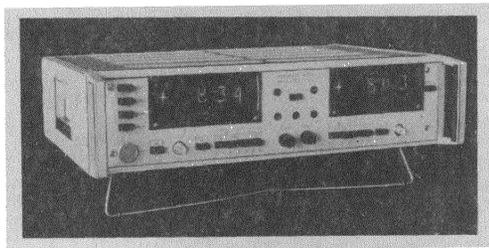
Рис. 83. Феррометр цифровой типа Ф5063
