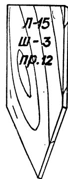
Рис. 18. Образец деревянной бирки, установленной на проходке
