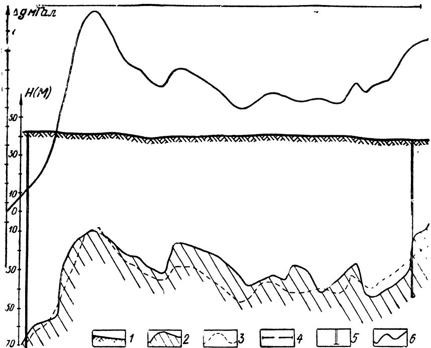
Рис. 23. Сопоставление данных интерпретации гравиразведки с последующим бурением:
