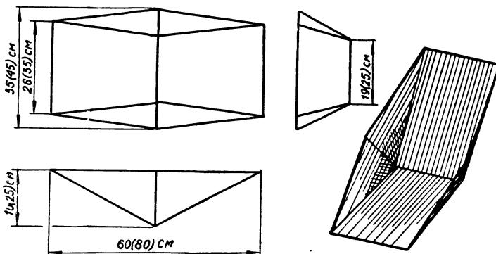
Рис. 20. Лоток для промывки проб
