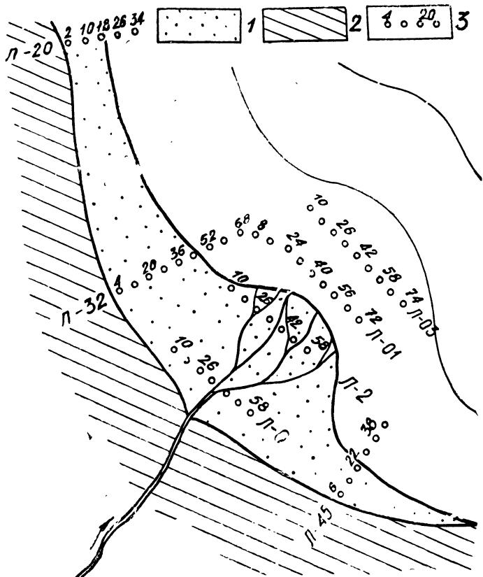
Рис. 8. Порядок нумерации разведочных линий и выработок при разведке прибрежно-морских россыпей:
