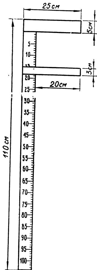
Рис. 30. Измерительная линейка
