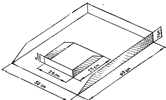
Рис. 26. Совки для отдувки шлиховых проб.
