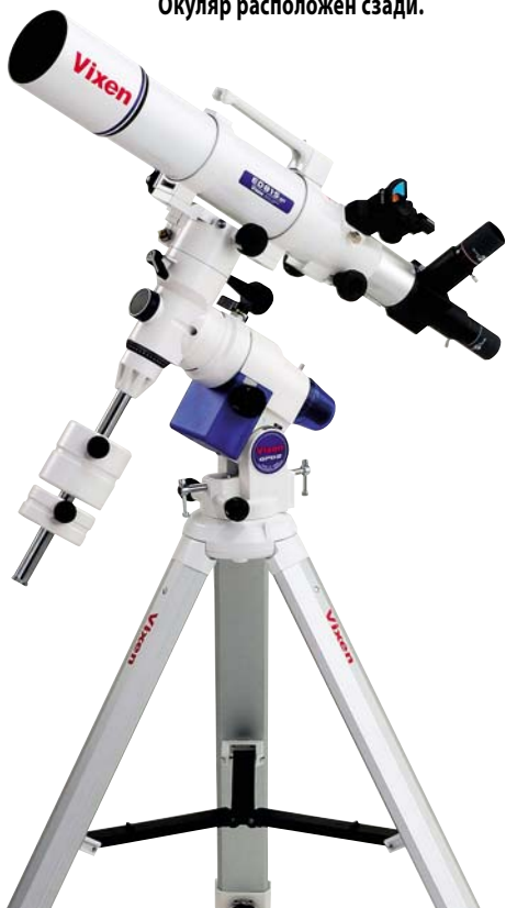
Линзовый телескоп (рефрактор). Окуляр расположен сзади.
