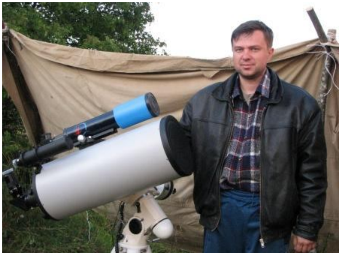
Владислав Оноприенко (г. Краснодар) и его телескоп МК «Сантел» ( d=228\text{мм} , f=3000\text{мм} ) установленным на экваториальной монтировке EQ6.
