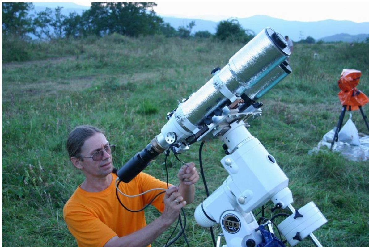
Павел Глод (г. Рига) подготавливает к работе свой двухэлементный апохроматический рефрактор ED80 ( d=80\text{мм} , f=600\text{мм} ) с камерой QHY8Pro на экваториальной монтировке EQ6. (Фото Ивана Мхитарова)
