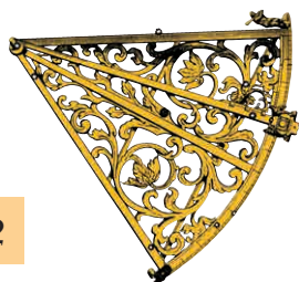
Секстант — астрономический прибор для измерения высот светил над горизонтом с целью определения координат места наблюдателя
